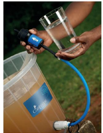
Der Filter (von Sawyer) funktioniert ähnlich wie eine Nieren-Dialyse. Jeder Filter hat viele winzige Schläuche mit hunderten von Poren, die ungefähr hundertmal kleiner sind als der Durchmesser eines Haars. Nur das saubere Wasser gelangt durch diese Poren, während die Bakterien aufgehalten werden.
